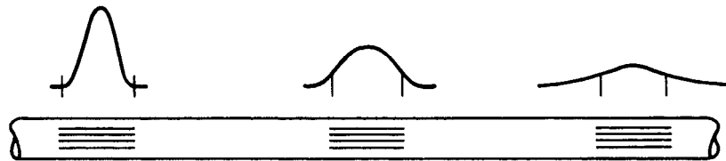
Slika 1: Razširitev impulza pri potovanju po optičnem vlaknu.
