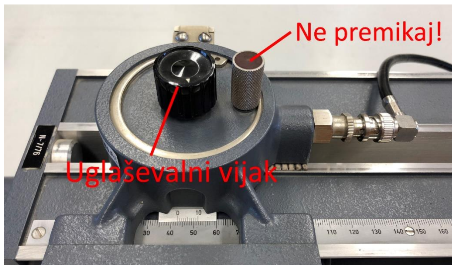
Slika 5: Položaj uglaševalnega vijaka na premični sondi.
