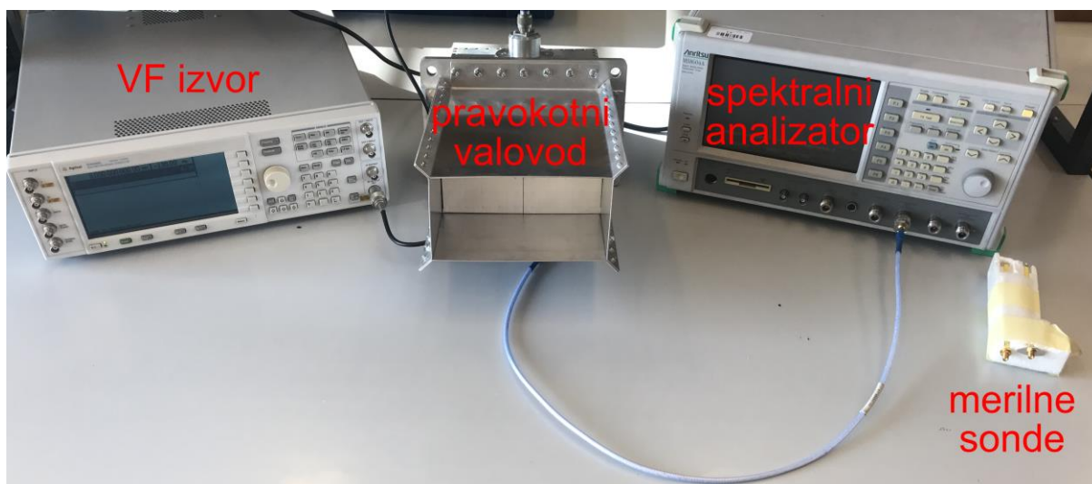
Slika 3: Slika vezave merilnih pripomočkov
