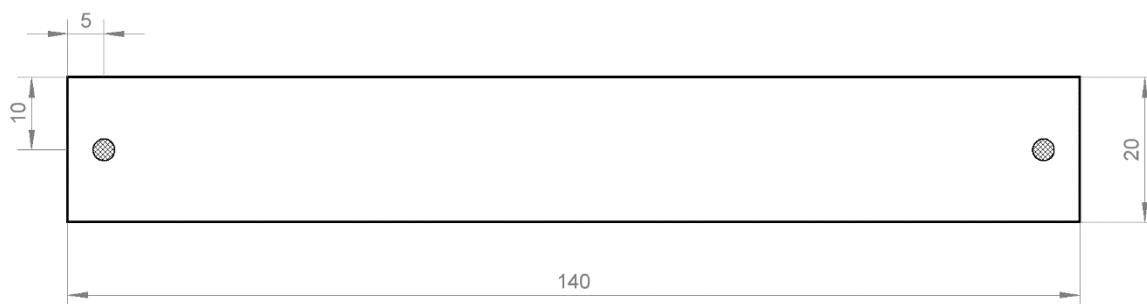
Slika 5: Mehanski načrt aluminijaste traku za izdelavo zančne antene
