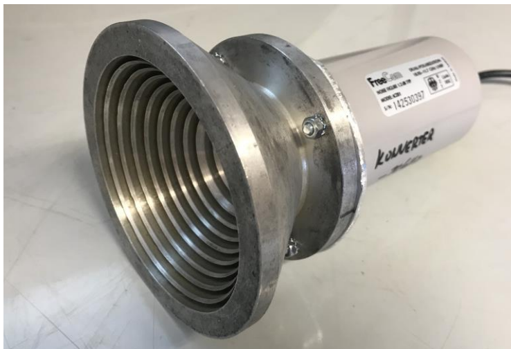
Slika 5: Korigiran lijak z nameščenim konverterjem in nizkošumnim ojačevalnikom
