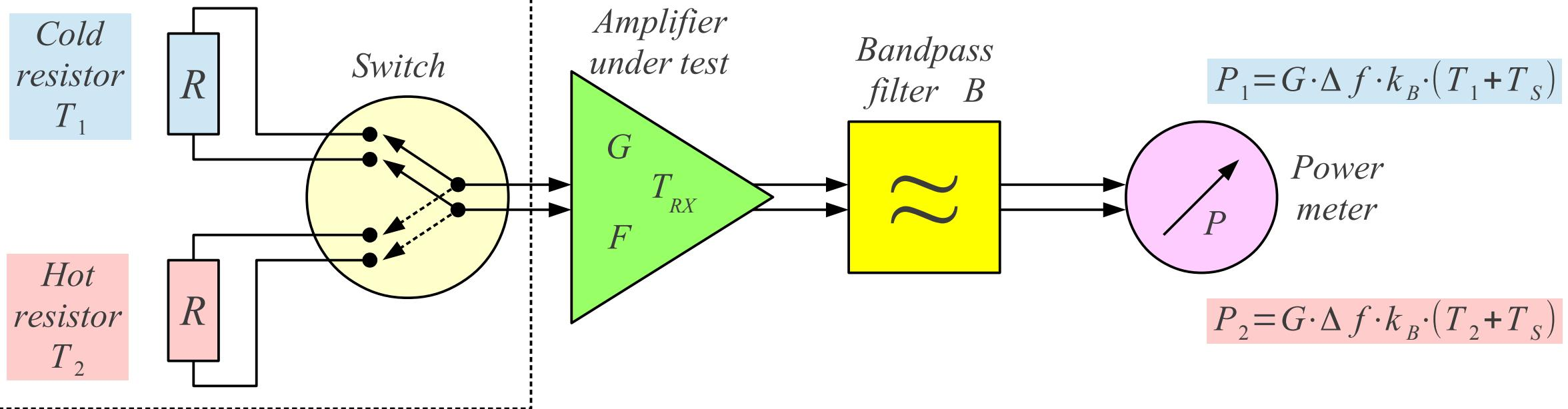
$$Y = \frac{P_2}{P_1} = \frac{G \cdot B \cdot k_B \cdot (T_2 + T_{RX})}{G \cdot B \cdot k_B \cdot (T_1 + T_{RX})} = \frac{T_2 + T_{RX}}{T_1 + T_{RX}}$$
