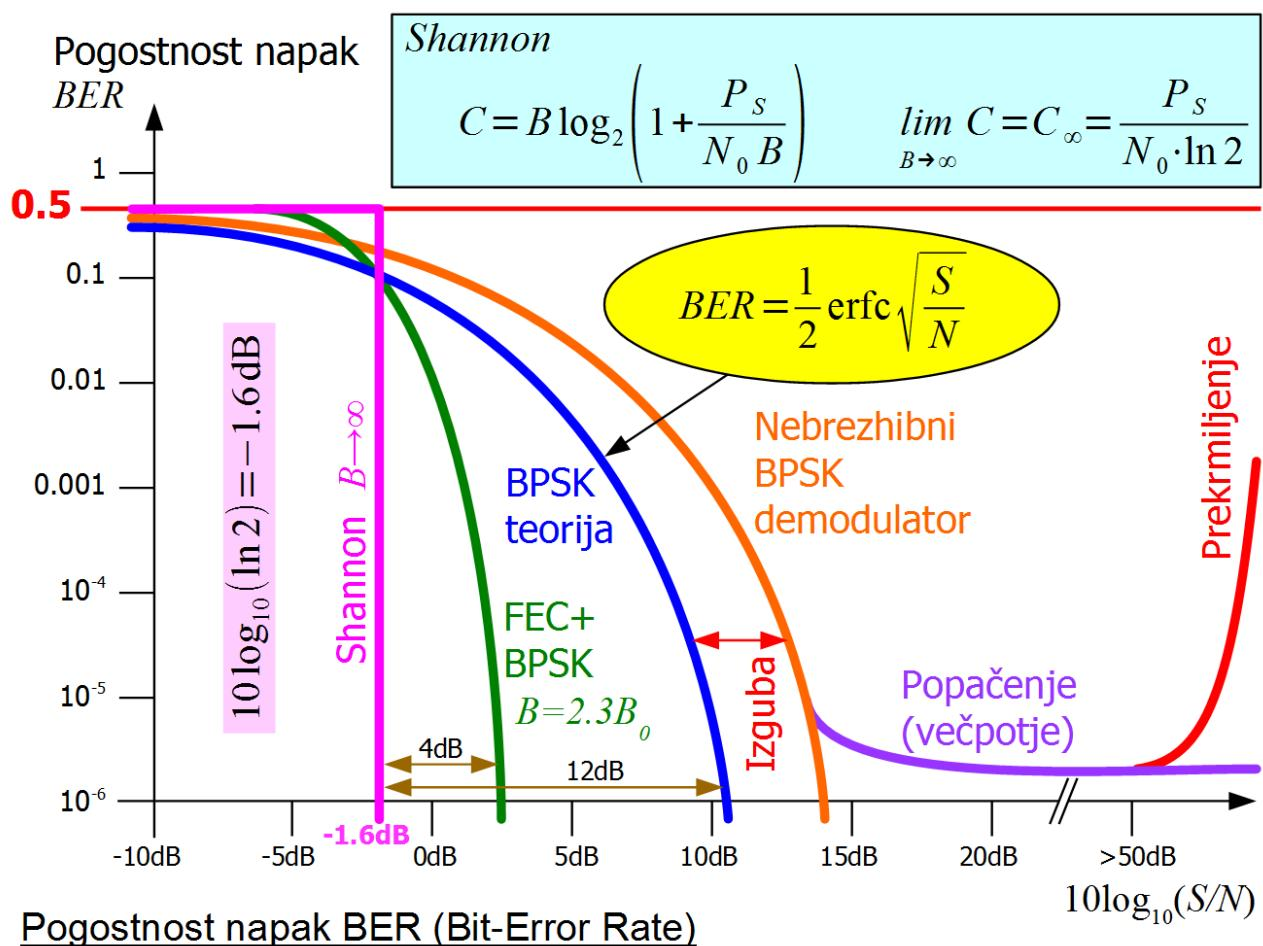
Bolj pogost pojav je poslabšanje kakovosti zveze zaradi popačenj v oddajniku, prenosni poti in sprejemniku. Že samo omejevanje signala v sprejemniku oziroma trdo odločanje v demodulatorju prinese izgubo 2dB glede na idealni slučaj. Povrhu šum moti delovanje regeneracije nosilca v sprejemniku, česar opisana izpeljava pogostnosti napak ne upošteva. Resnični BPSK sprejemnik zato ne more doseči niti krivulje pogostnosti napak za idealni BPSK demodulator.
