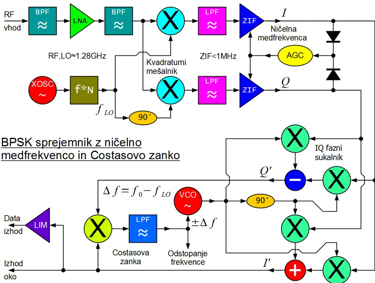
Demodulirana signala  $I'$  in  $Q'$  proizvede šele kvadraturni fazni sukalnik, ki se vrti z natančno sinhronizirano razliko frekvenc
