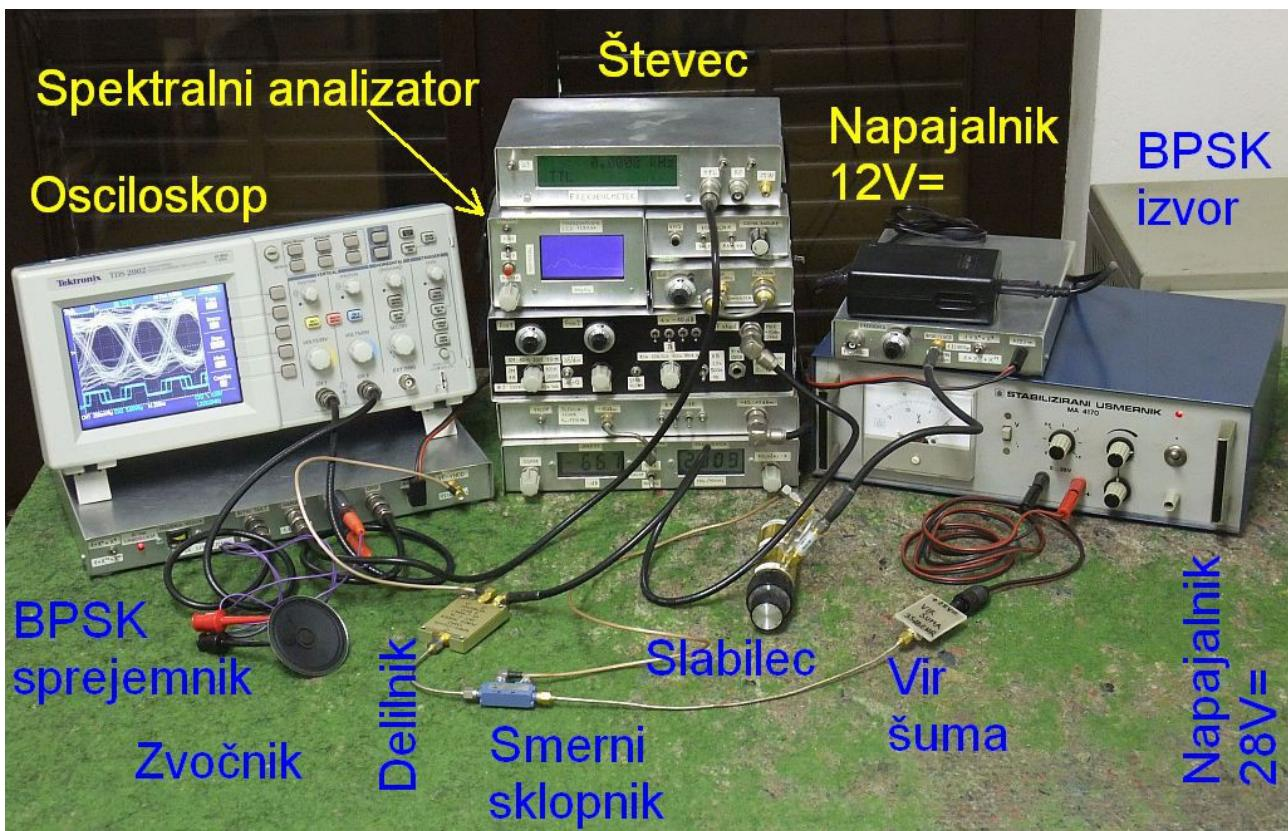
Vhodno razmerje signal/šum odčitamo na spektralnem analizatorju. Pri tem nastavimo širino medfrekvenčnega sita spektralnega analizatorja vsaj 10-krat ožjo od glavnega lista spektra BPSK modulacije. Na ta način opazujemo tudi BPSK signal kot šum in velja za signal in za šum isti faktor povprečenja (običajno 2.51dB), ki se v merjenem razmerju signal/šum natančno krajsa, ko vključimo video sito na spektralnem analizatorju.
