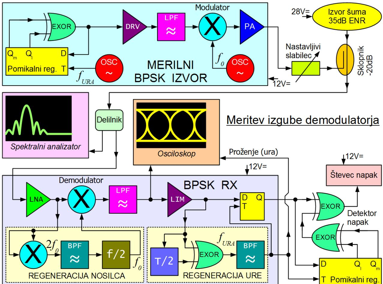
Na drugem koncu merjene zveze preverjamo sprejeto zaporedje z vnaprej znanim vzorcem. V ta namen potrebujemo povsem enak generator zaporedja s pomikalnim registrom, ki ga moramo sinhronizirati z enakim registrom v oddajniku. Najenostavnejša rešitev je uporaba polinomskega delilca, ki se sam sinhronizira na vstopne podatke. Na izhodu polinomskega delilca sicer dobimo za vsako napako tri ali več impulzov, ustrezno številu od nič različnih členov polinoma oziroma odcepov pomikalnega registra.
