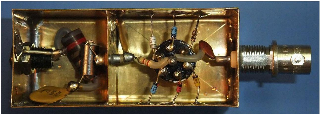
Vezje vsebuje tudi sklopni kondenzator 1nF na izhodu, ki ustavi enosmerno komponento. Vdor motenj preprečuje tudi nizkoprepustno sito z dvema kondenzatorjema 10nF in feritno dušilko na napajanju. Enosmerni tok skozi izbrano diodo je omejen z dvema uporoma 820Ω in 180Ω, ki dajeta v zaporedni vezavi natančno 1kΩ za lažje preračunavanje tokov in napetosti.
