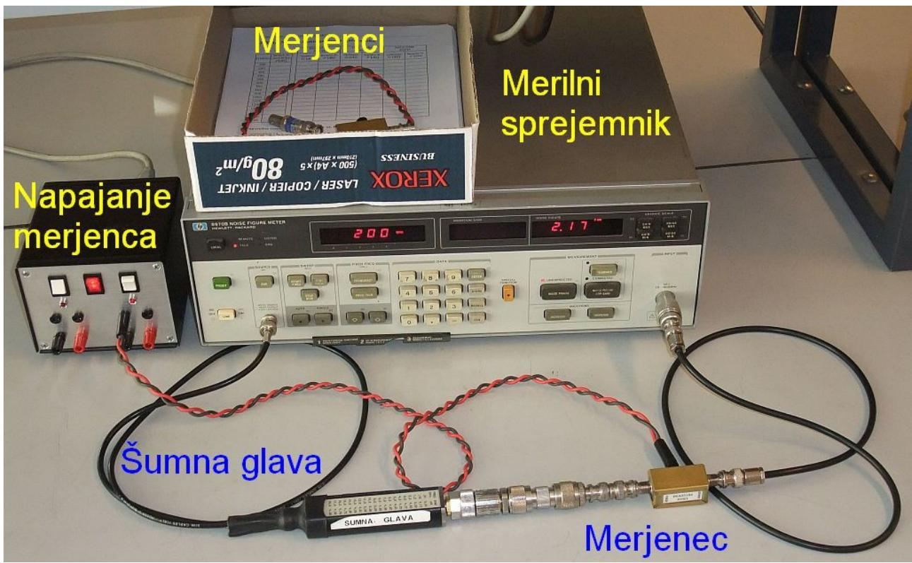
V merilniku šumnega števila je treba izmerjeno veličino  $Y$  pretvoriti v končni rezultat  $F$ . Analogni merilniki šumnega števila imajo v ta namen le primerno izrisano skalo na merilnem inštrumentu. Ena sama skala seveda velja le za povsem določeno vrednost ENR šumne glave. Sodobni merilniki šumnega števila so opremljeni z mikroračunalnikom za preračunavanje
