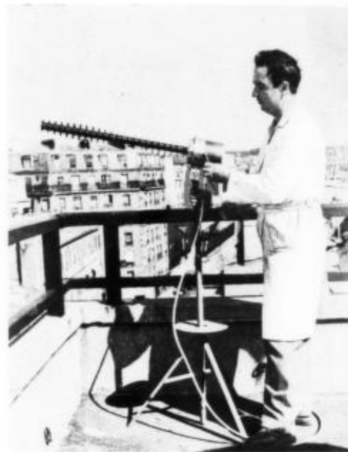
Fig. 14. — Antenne cigare à deux éléments \frac{L}{\lambda} = \frac{1}{4} fonctionnant de 1700 à 2000 Mc/s.
