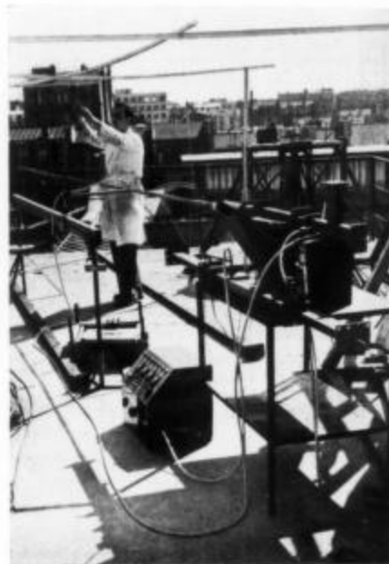
Fig. 8. — Mesure de phase le long d'une antenne de 80 \lambda en diélectrique artificiel.
