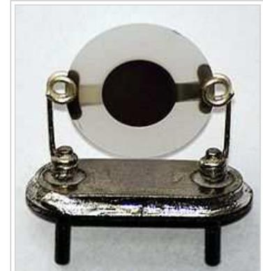
Metallisierter Quarzresonator, gehalten durch eine Federhalterung
