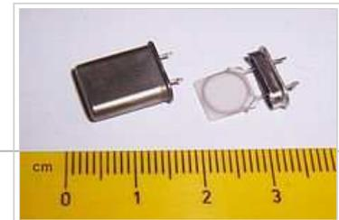
Schwingquarz für eine Frequenz von 4 MHz
