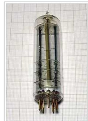
Niederfrequenz-Schwingquarz aus den 1960er Jahren in einer evakuierten Röhre mit einem damals üblichen Röhrensockel
