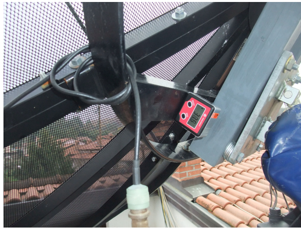
Slika 3.1: Meritev prilagojenosti žarilca pritrjenega na zrcalo
