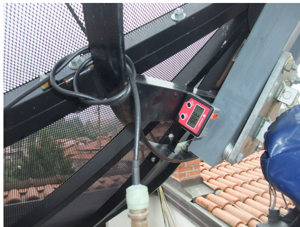
Slika 3.1: Umerjanje teleskopa s pomočjo kotomera
