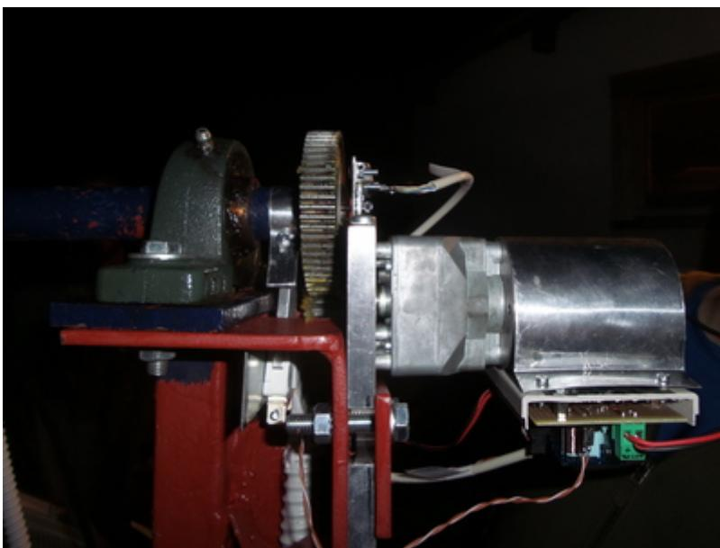
Motor in prenos za obračanje elevacijske osi. Pogled s strani, na vrhu se vidi senzor zasuka osi.
