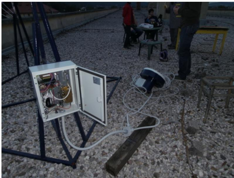
Pogled v nameščeno omarico, v kateri domuje večina elektronike. Zraven se vidi "hobotnica" kablov, ki povezujejo periferne naprave (predajačevalnik, motor, senzor) z omarico in dovajajo napajanje ter mrežni dostop do računalnika.
