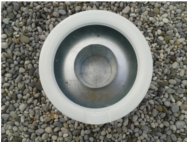
Sprejemni lonec, fotografiran z vrha. Notri se lepo vidi sprejemna palčka. Beli plastični obroč (nekoč okvir vrat pralnega stroja) je nosilec za ravno ploščo pleksi stekla, kar preprečuje vdor vode in hkrati še vedno omogoča pogled v sprejemni lonec (didaktična nujnost!).
