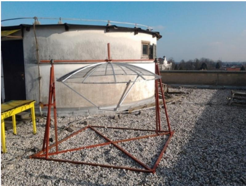
Antena, obešena na stojalu. Manjkajo še protiutež, sprejemni lonec, motor in vsa elektronika. Lepo se vidi pritrdilni sistem za sprejemni lonec.
