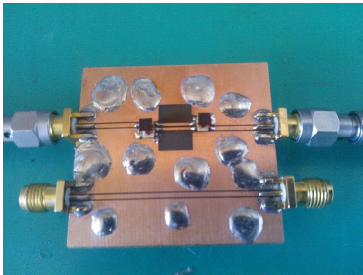
Slika 4.6: Vezje za merjenje karakteristika širokopasovnega baluna
