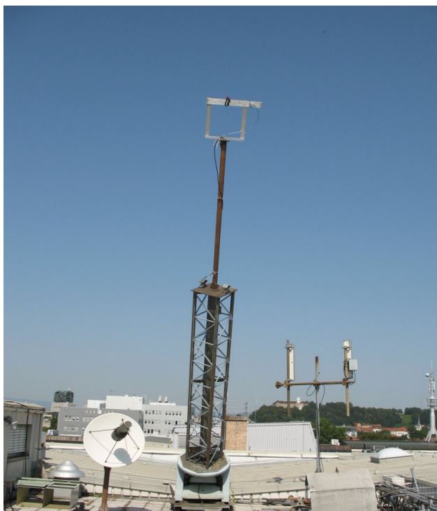
Slika 3.41: Valobni vodnik dvignjen na vrtiljaku z laserjem.
