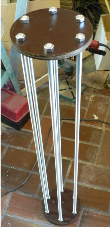
Slika 3.26: Končano stojalo za meritev horizontalne polarizacije.
