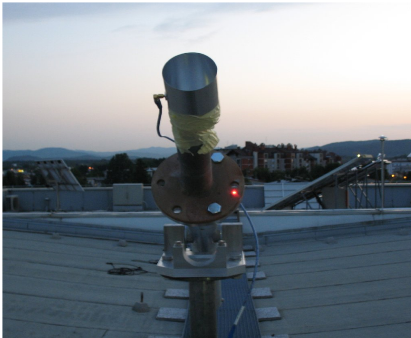
Slika 3.43: Usmerjanje valovnega vodnika proti žarilcu s pomočjo laserja.
