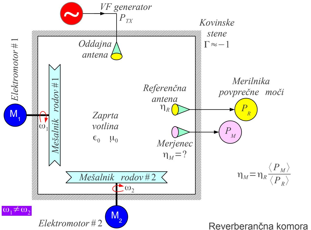
V reverberančni komori merimo povprečne pretoke moči. V primeru več mešalnikov rodov dobimo bolj naključne razmere, ko mehanska vrtenja posameznih mešalnikov  $\omega_1 \neq \omega_2$  niso sinhronizirana med sabo. Z večanjem smernosti  $D$  merjenca se veča tudi zahteva po številu rodov  $N$  in z njim izmere votline. Pravilno delovanje reverberančne komore lahko preverimo z merjenjem statistike amplitude in faze sprejetih signalov.
