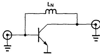
Fig. 10 AC Equivalent Circuit
