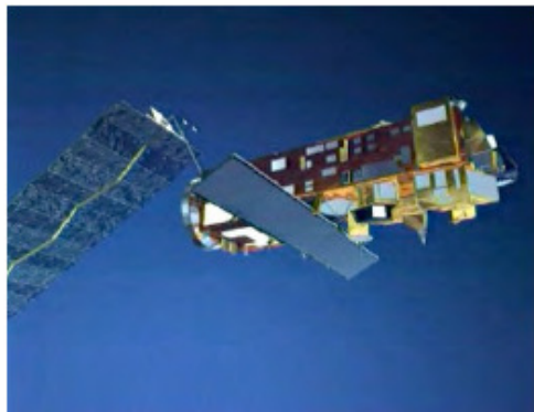
ENVISAT / ASAR ESA (EU) 2002 C-Band (Sngl / Twin) HH, VV, (HH,VV), (HH,HV), (HV,VV)
